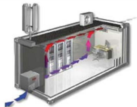
Рис. 3. Система фрикулинга раздельного типа на базе FREE-AIR 3
